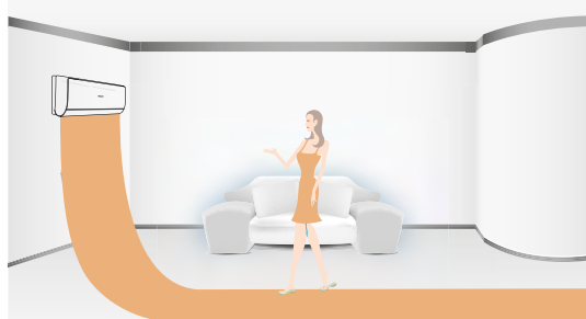
В режиме обогрева теплый воздушный поток направляется почти вертикально вниз для более интенсивного прогрева воздуха в помещении.
